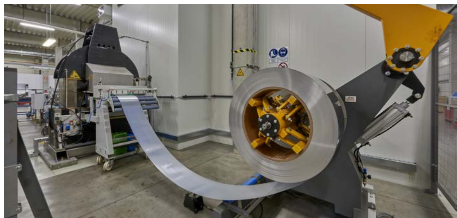
Abbildung 7-7: Beispiel einer kontinuierlichen Produktionslinie für die Herstellung von Bipolarplatten – Hydrogate Pressenlinie [Borit NV]
